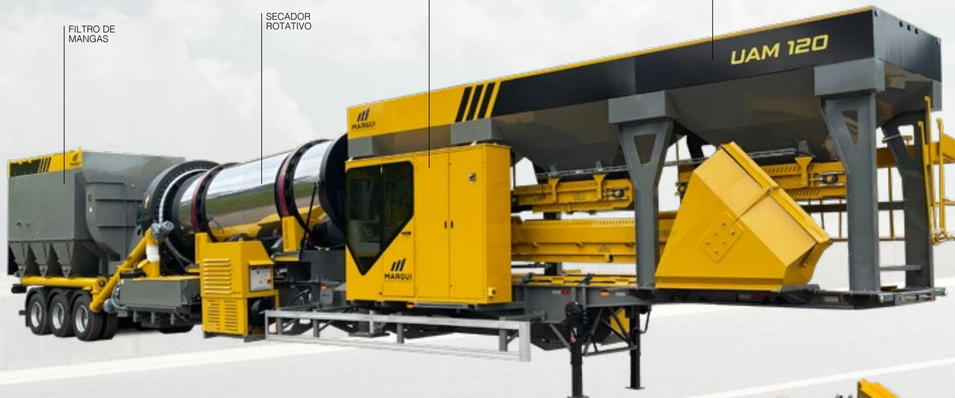
Usina de asfalto a quente (CBUQ), do tipo contrafluxo, para produções de até 120 toneladas de asfalto por hora, com misturador externo de eixo duplo, controle automático e manual da produção, controle de temperatura e filtragem dos gases.
